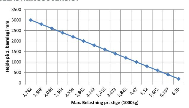
Herover: Belastningsdiagram der viser højden på 1. bærelag kontra max. belastning pr sektion.
